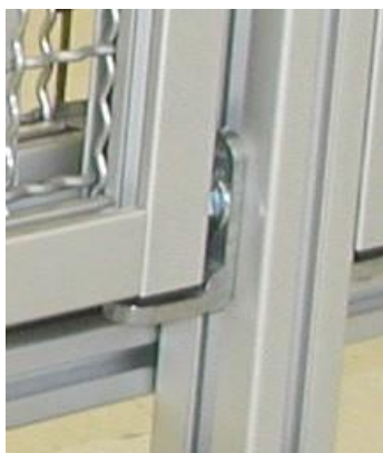
Пример монтажа уголка для навески
